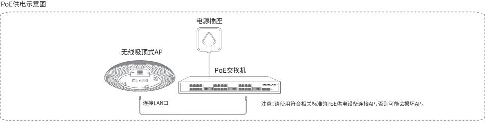
❖设备安装中涉及到的所有视图仅为示意,请以实际形态为准。以安装MCAP300P为例介绍。
