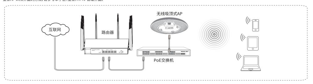
•FIT AP模式 当用户需要组建的无线网络规模较大时,若单独管理网络中的每一个AP,将使得网络管理工作繁琐且复杂,此时,推荐用户在网络中搭建一台无线控制器(AC)产品,由无线控制器统一管理网络中的所有AP,
